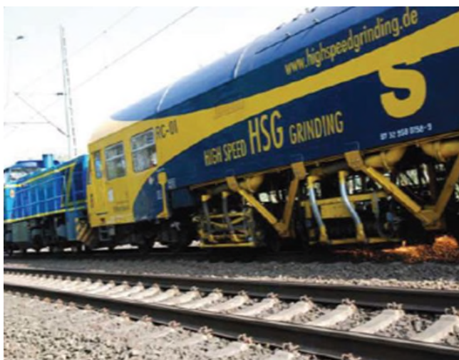
3.14.2. attēls. Sliedes deformācijas un vilciens sliežu slīpēšanai
