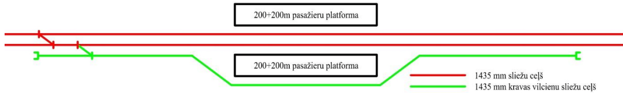
1.6.13. attēls. Sliežu ceļu shēma starptautiskajā lidostā "Rīga"
